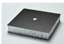
太陽電池パネルに用いる CFRP と アルミハニカムのサンドイッチ構造体
