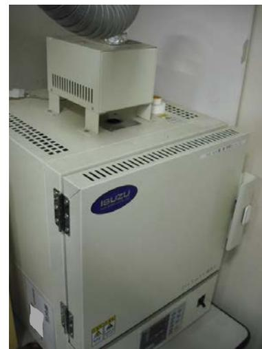
JIS K 7052 焼成法（電気炉）
