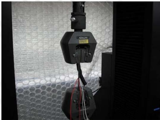
CFRP 引張試験
