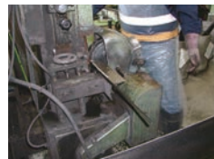
テープを剥がすと凹凸がでる各スベックを満たすため全体を研削する
